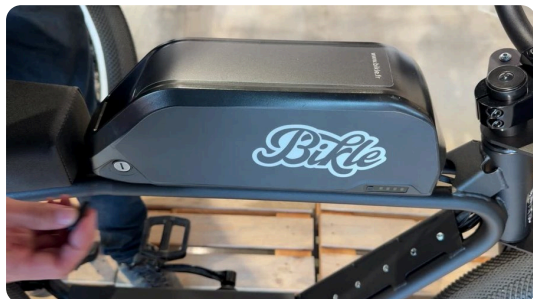
Retrait : quart de tour de la clé, glissement vers l'arrière, puis on soulève.
