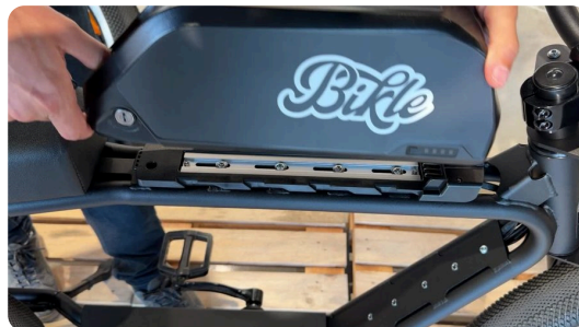
Pose : avant en retrait d'environ 1 cm, puis poussée vers l'avant jusqu'au « clac ».
