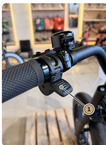
La gâchette d'aide au démarrage (repère 1), à gauche du guidon.
